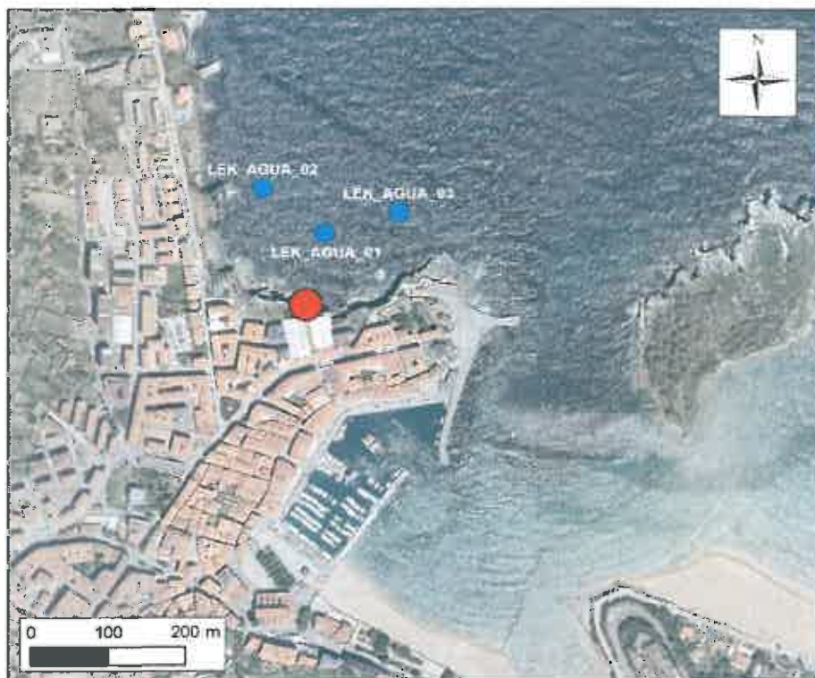
Figura 1. Situación de las estaciones de muestreo de calidad de aguas en el entorno de los vertidos de la EDAR de Lekeitio. Las coordenadas de cada estación se presentan en la Tabla 1. El punto de vertido se señala con círculo rojo.
