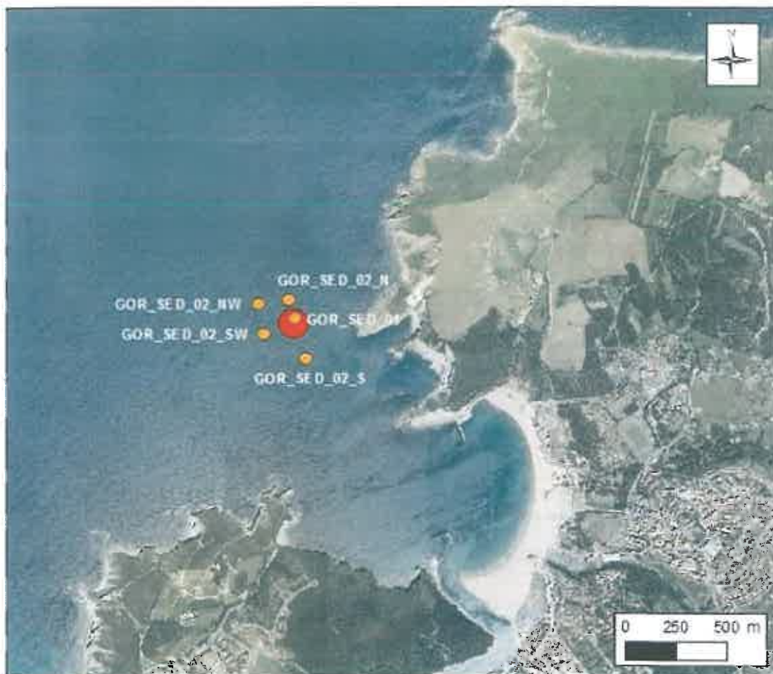
Figura 2. Situación de las estaciones de muestreo de sedimentos y bentos de fondo blando en el entorno de los vertidos de la EDAR de Gornitz. Las coordenadas de cada estación se presentan en la Tabla 4. El punto de vertido se resalta con círculo rojo.
