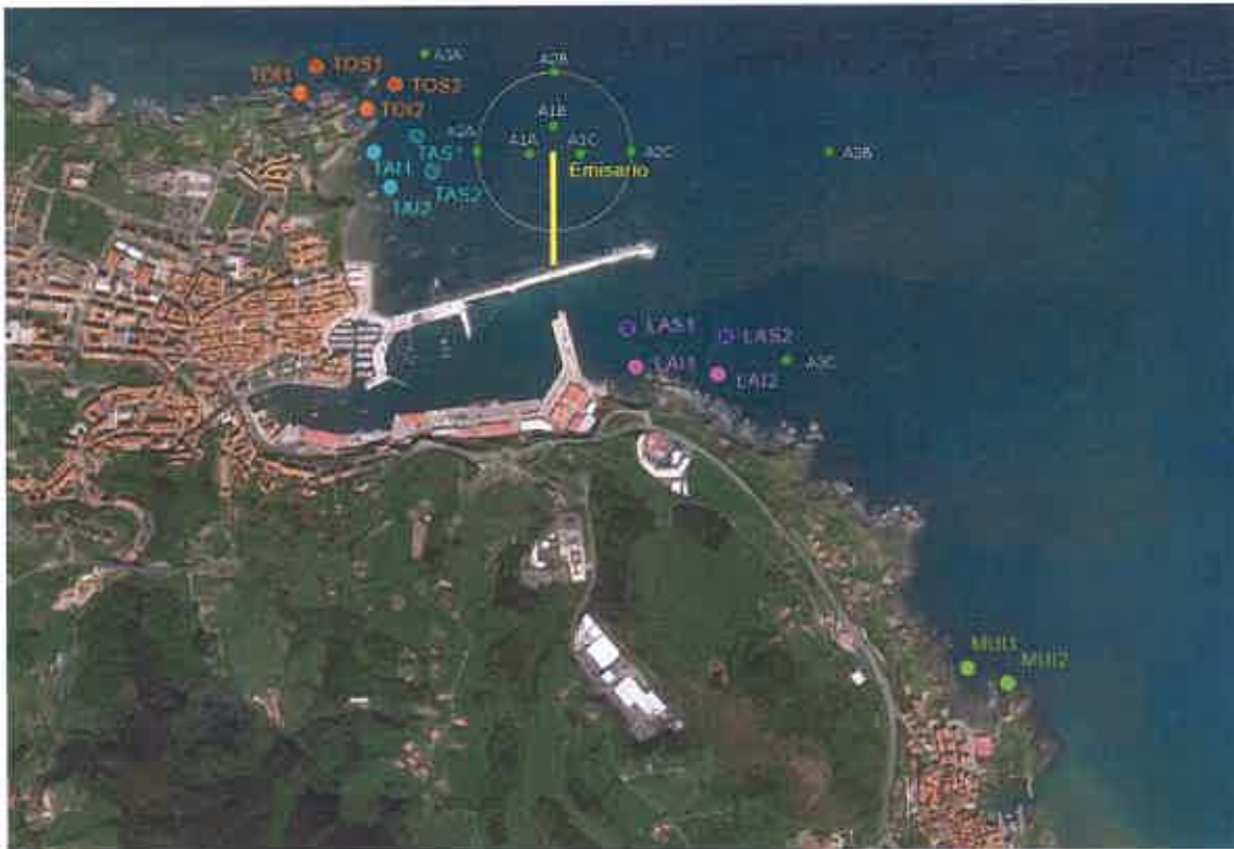
Fig. 3. Plan de Vigilancia de la EDAR de Lamiaran (Bermeo). Detalle de la localización de las estaciones. Estaciones para las variables fisicoquímicas y la variable clorofila a (círculos color verde). Estaciones para el estudio del bentos de sustrato duro (TO: Tonpoi; TA: Talaípe; LA: Lameropunte; MU: Mundaka; subtítulos etiquetas: I1 e I2, Intermareal Area 1 y Area 2; S1 y S2, Submareal Area 1 y Area 2).
