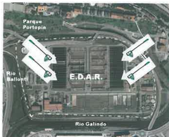
Figura 1: Distribución de los puntos de toma de inmaduros en los clarificadores de Decantación Secundaria
