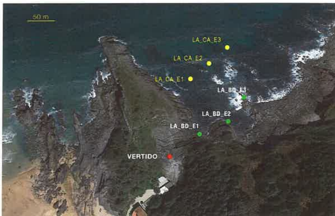
Fig. 4. Plan de Vigilancia de la EDAR de Laga. Detalle de la localización de las estaciones en la zona potencialmente afectada por el vertido (ensenada de Galdaraposo y entorno; círculo rojo: punto de vertido). Los círculos verdes corresponden a las estaciones del bentos de sustrato duro intermareal. Las estaciones para las variables fisicoquímicas de la columna de agua quedan indicadas con un círculo amarillo.
